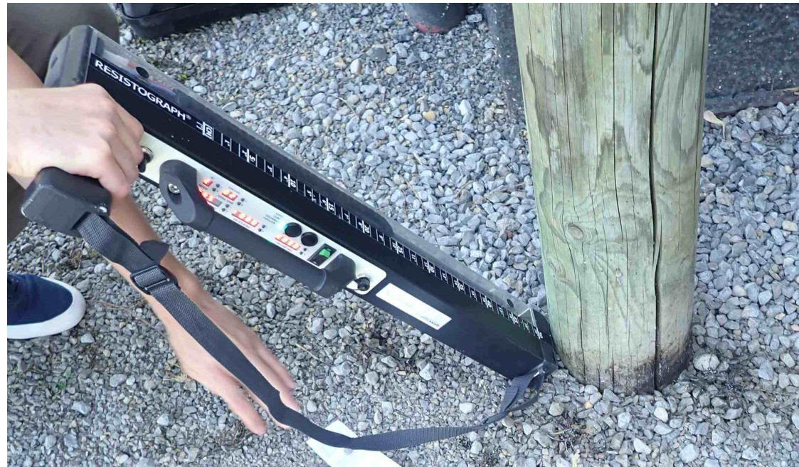
Bohrwiderstandsmessungen an Holzmasten
